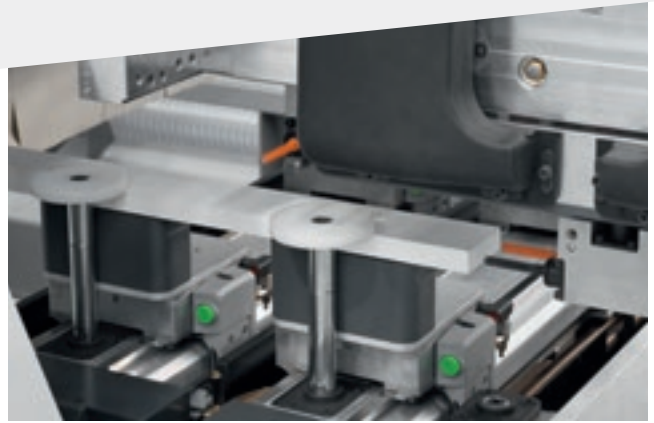
Easyclamp-Aufspannsystem für die Bearbeitung schmaler Werkstücke.
